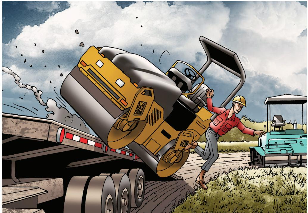
un pie, la compactadora se volvió inestable y empezó a resbalar por el borde de la rampa y se volteó. El conductor saltó de la compactadora, pero fue golpeado por el sistema ROPS de protección de caídas y aplastado contra el suelo. Más tarde moriría a causa de sus heridas.
